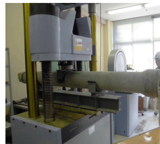
曲げ試験状況
